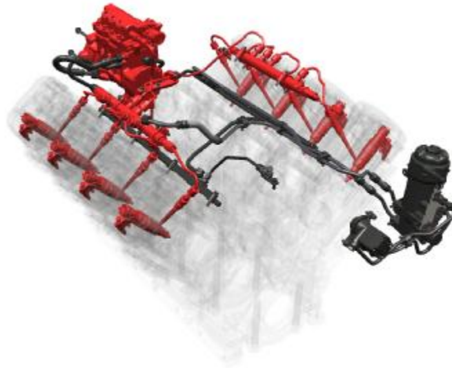
System vstřikování paliva Scania XPI na motoru V8
